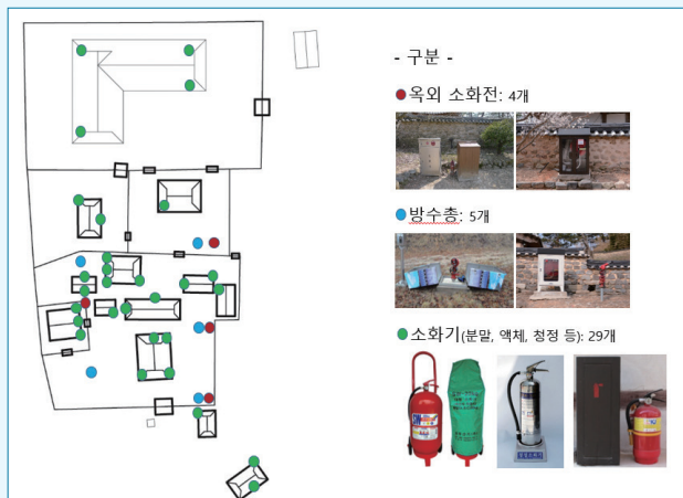
소수서원 소방시설 | Firefighting equipment at Sosu-seowon
